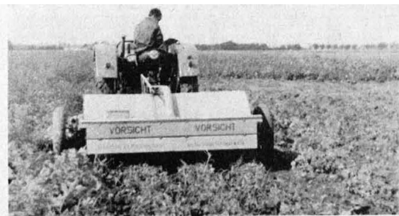
Foto: Jordan Dreireihiger Krautschläger der Landmaschinenfabrik Essen
